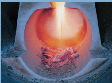
Hoření plamene v keramické spalovací tvarovce
